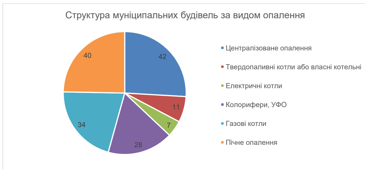
Рис.Д2.4. Структура муніципальних будівель за видом опалення
